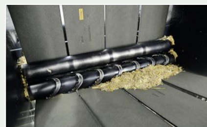
Die Abstreiferwalzen an beiden Kammerseiten sollen die Riemen von innen sauber halten und Verschmutzungen vorbeugen.
