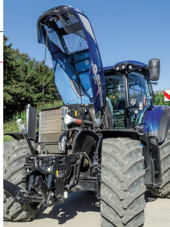
Große Klappe, aber auch ordentlich was dahinter: Das FPT-Aggregat mit 6,7 l Hubraum ist stark und sparsam.
