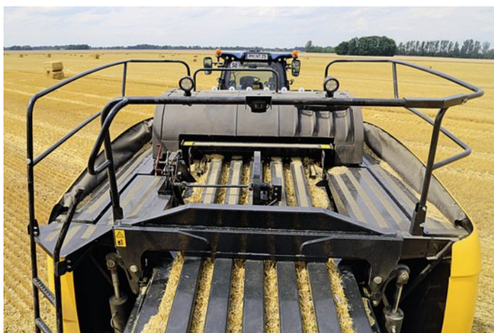
Das Geländer läuft bei den neuen Maschinen einmal rundum und ist bei Bedarf zum Transport oder Abstellen einfach abklappbar.
