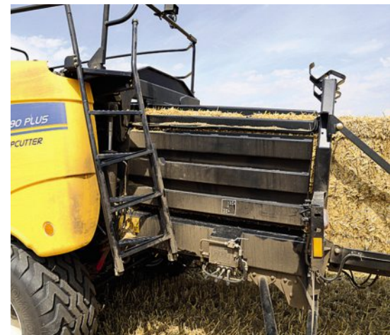
Die Ballenkammer hat New Holland um 80 cm auf jetzt 3,34 m verlängert.
