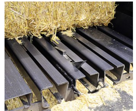
Die Größe und die Aggressivität des Ballenausstoßers hat New Holland für eine bessere Verzahnung im Ballen angepasst.
