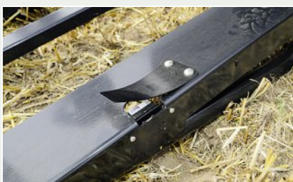
Der Sensor auf der Ballenrutsche registriert das erfolgreiche Ablegen des Ballens und gibt das Schließen der Heckklappe frei.
