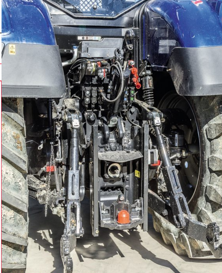
Bis zu 6 Ventile und 9,5 t Hubkraft sind prima! Warum die Schlauchanschlüsse der Hubzylinder drehbar sind, wissen wir nicht. Es sorgte aber für Leckagen.
