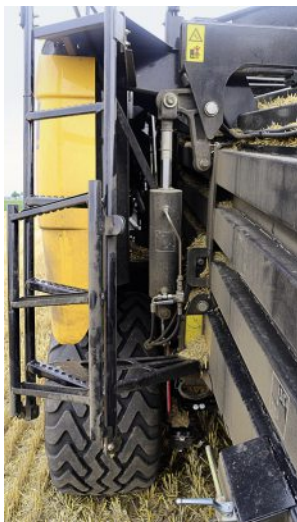
Den Abstand zwischen Maschine und Verkleidung wurde vergrößert, das soll Materialablagerungen vorbeugen.
