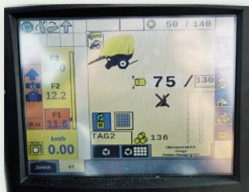
Ist das kleine grüne Sechseck mit den Pfeilen darin (oben links im Terminal) zu sehen, ist das IntelliBale-System aktiv.
