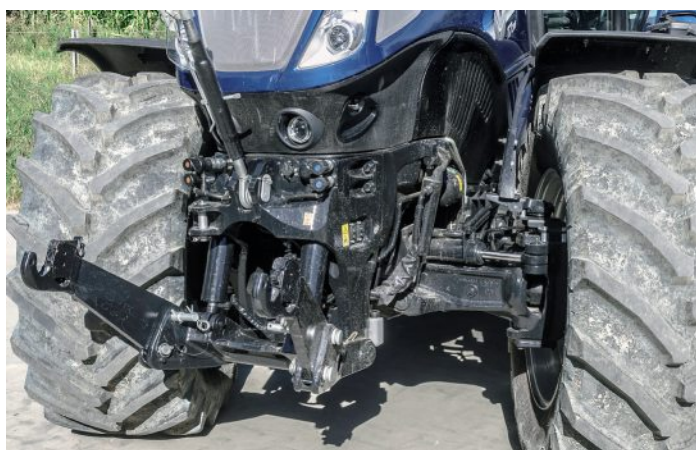
Die neue Federung hat außenliegende Zylinder und kann in drei Stufen eingestellt werden. Das Fronthubwerk hebt mehr als 4,5 t.
